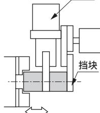
(注)由于工件在小爪上滑动,夹爪寿命可能会大幅降低。小爪的形状需要充分考虑。
